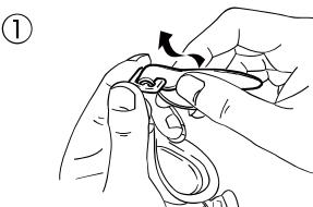
①ストラップの上側の1枚をねじって引っ張り、図のようにフックから外し、ストラップアジャスターの穴から抜きます。※ストラップが切れることができますので、外す時は爪をたてないように注意して下さい。
