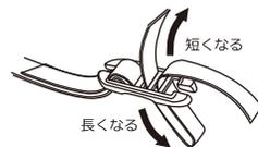
② 図のようにストラップアジャスターにストラップを通し、ご自分に合う長さになるようストラップを調節します。
