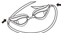
① 図のようにストラップを左右ともに、レンズ端の穴に前から後ろへ通します。
