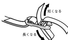
図のように順番に、ストラップアジャスターを通し、ご自分に合う長さになるようストラップを調整します。
