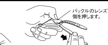
イラストを参考にバックルを押してストラップを矢印方向に引っ張るとストラップの長さを縮めることができます。
